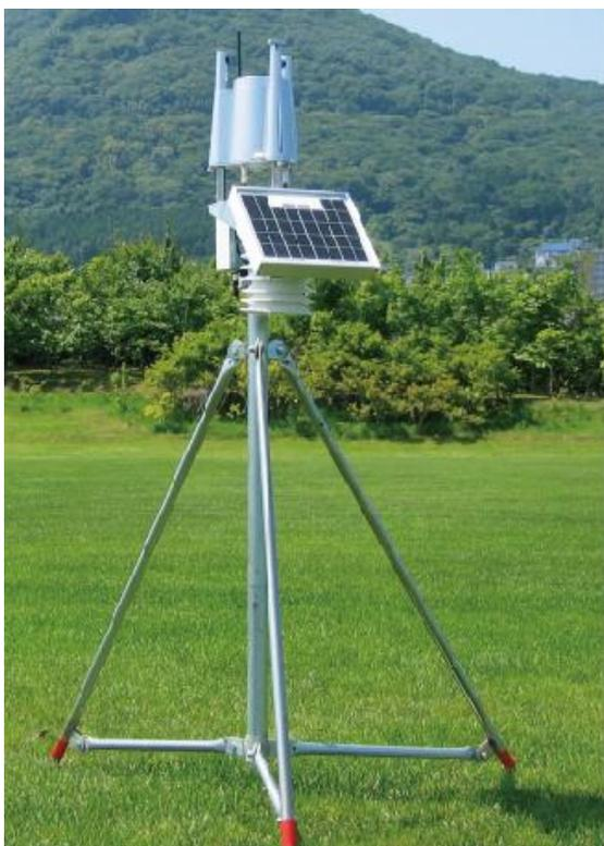
★Измеряемые параметры: температура воздуха, относительная влажность, температура точки росы, количество осадков, давление воздуха, солнечная радиация (интегральная оценка), скорость ветра (средняя, максимальная мгновенная), направление ветра (среднее, направление максимальной скорости), температура почвы.
